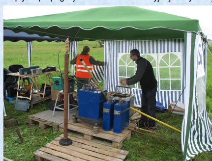
Generator udarowy do 16 kV, montowany pod namiotem
