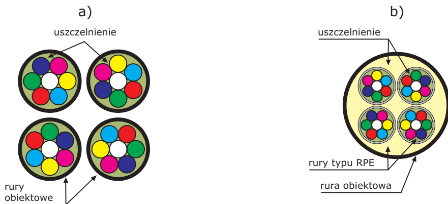
Rys. 46. Dozwolone przekroje przejść obiektywych dla rurowciągów sieci szkieletowej: a) oddzielne rury obiektywne, b) jedna rura obiektywa. 14
