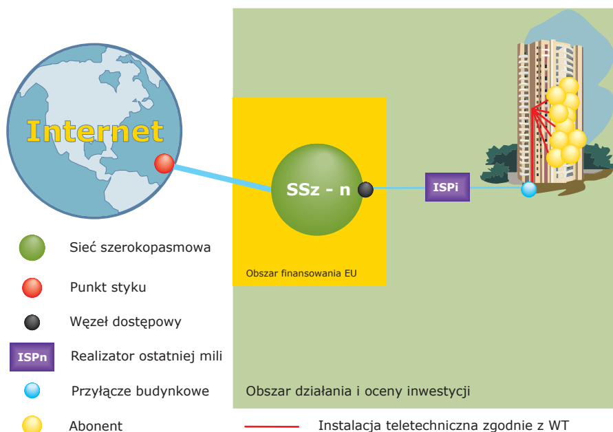
Rys. 22. Instalacja wewnątrzbudynkowa ostatnim elementem dostępu do Internetu
