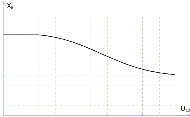
Rys. 2.21. Zależność wartości reaktancji X_\mu od napięcia zasilającego
