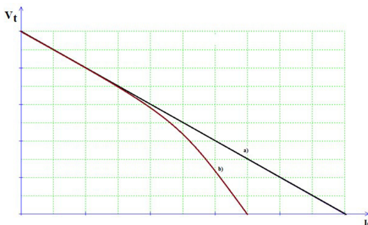
Rys. 1.24. Charakterystyka zewnętrzna generatora obcowzbudnego
