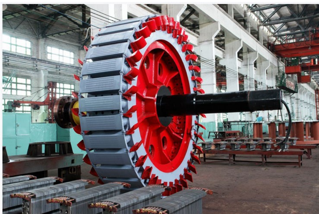
Rys. 2 Przykład wirnik hydrogeneratora [13].
